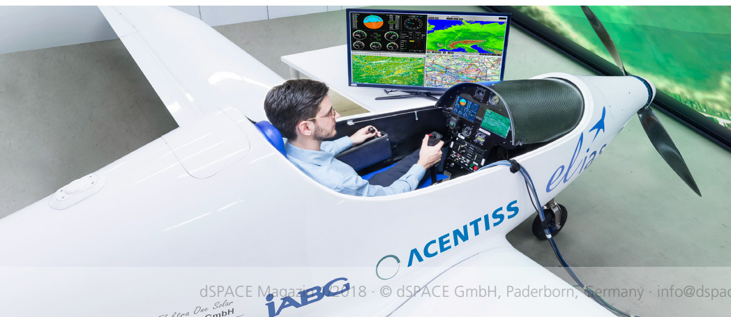
Abbildung 1: Mit Hilfe einer „Aircraft-in-the-Loop“-Simulation werden die Flugregelalgorithmen bereits am Boden umfassend getestet.
