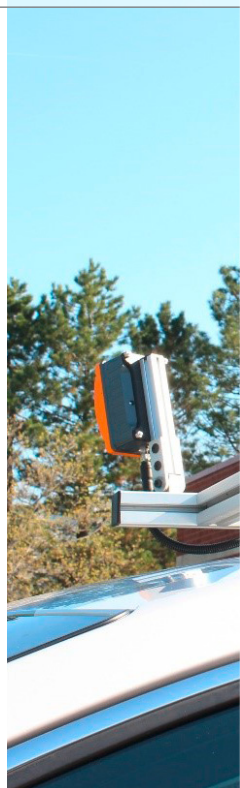
Das Demofahrzeug für die ADAPT-Plattform von P3 verfügt über einen PC mit RTMaps für die Datenaufzeichnung und einen Sensorsatz (Lidar, Ultraschall, Frontkamera, Frontradar).
